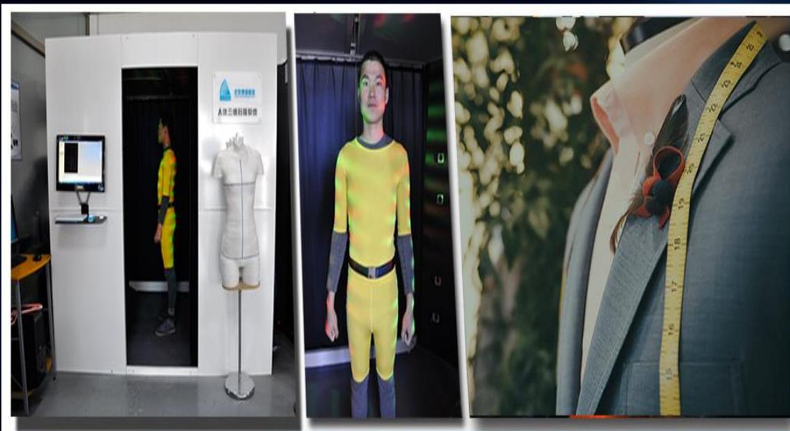
采用LED结构光扫描测量人体数据，与规定号型进行比对，确定礼服的尺寸规格；利用虚拟模特进行试衣，检验服装的松量度是否合适、结构线是否美观，再进行面料、花型的选择，观测整体着装效果。2017年《毕业季小礼服的立体造型》。
