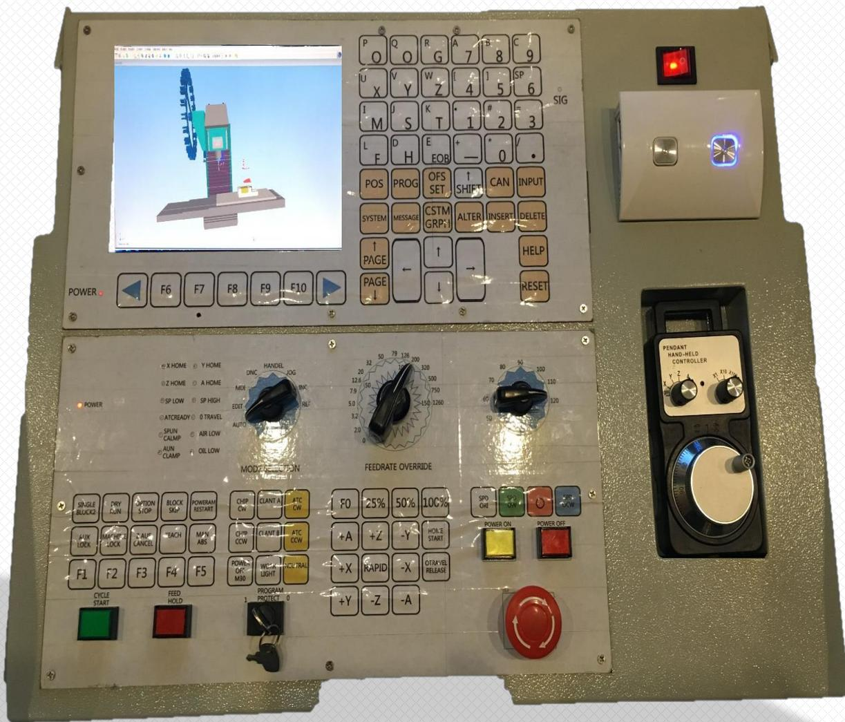
比之计算机上运行仿真软件，与实操设备相连接的“半实物”仿真系统更加贴近实际，能够更好训练学生设备操作的技能水平与规范要求。
